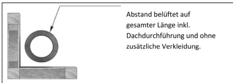
Abbildung 2: Abstand zu brennbaren Materialien
