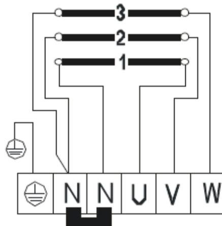
Abbildung 1: Anschluss-Diagramm
