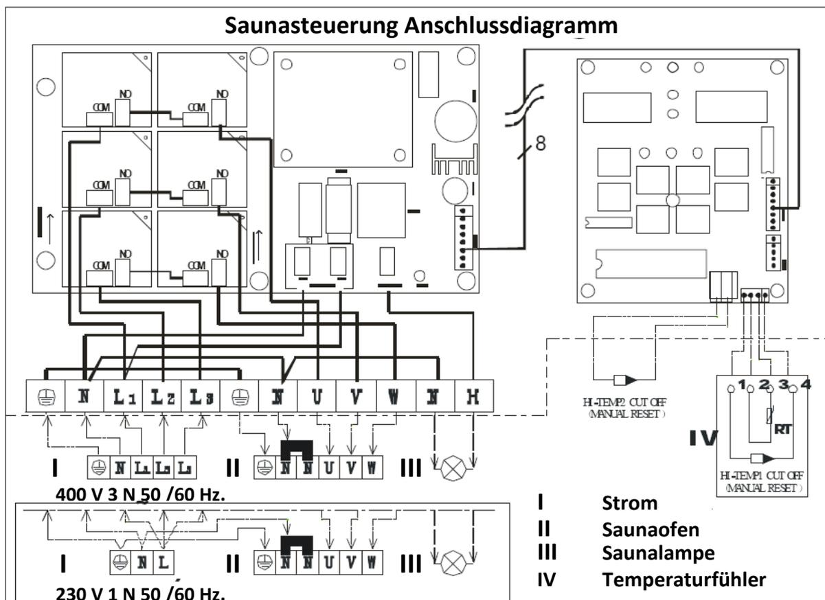
Abbildung 2: Anschluss-Diagramm Steuerung
