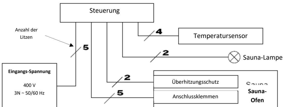
Abbildung 9: Klemmplan bei 400 V Betrieb
