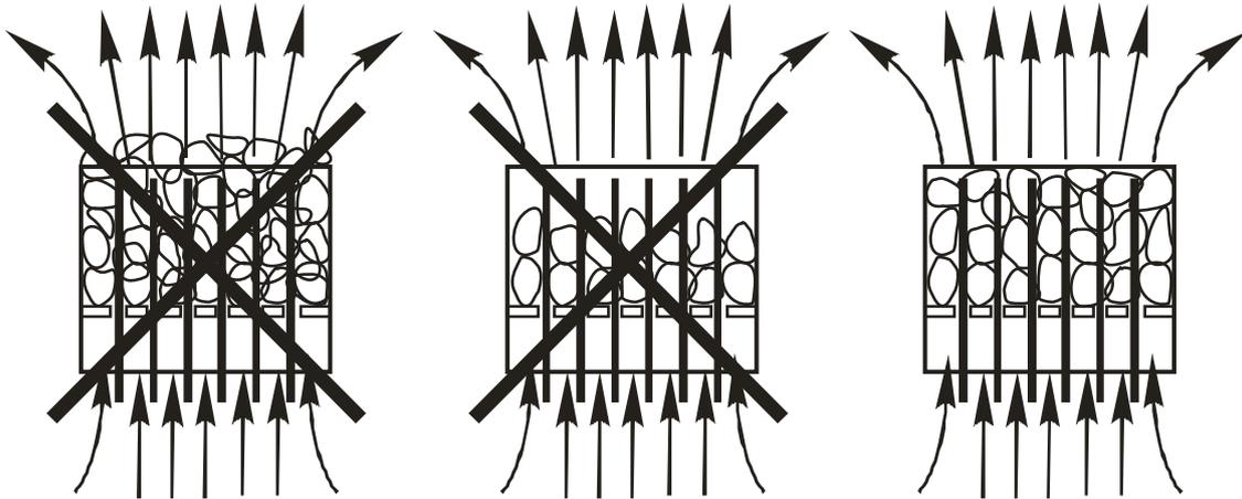
Abbildung 11: Das korrekte Befüllen mit Saunasteinen
