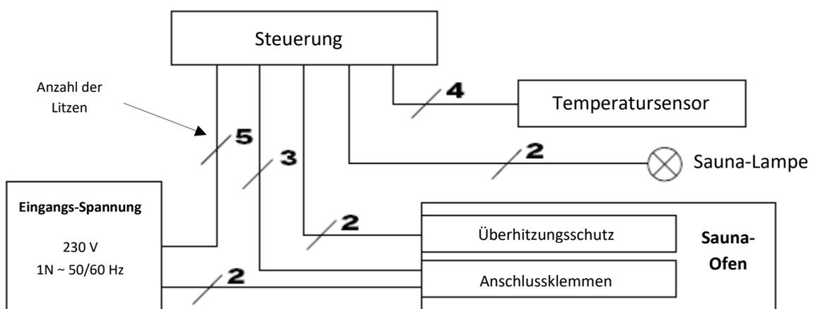
Abbildung 8: Klemmplan bei 230 V Betrieb
