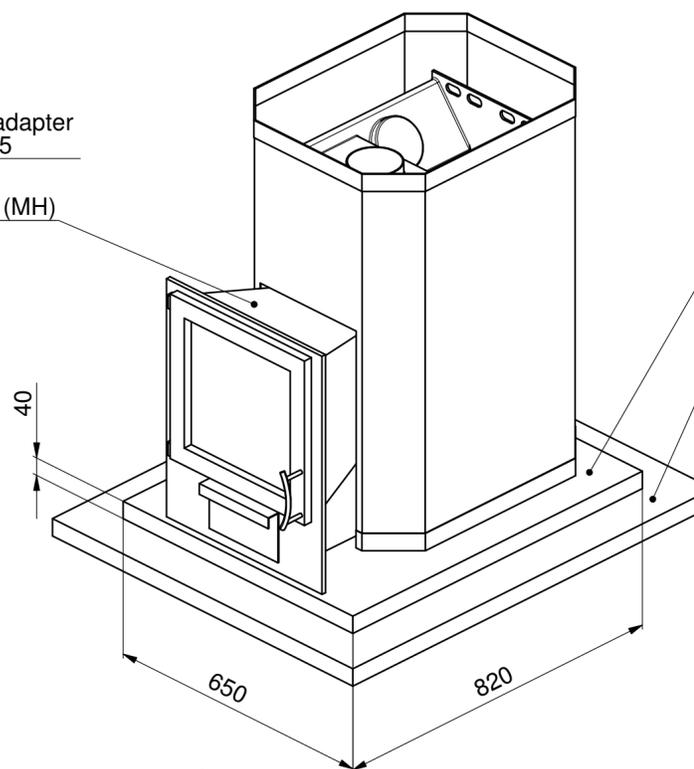
Betonplatte als Schutz für Böden aus **brennbaren** Materialien
