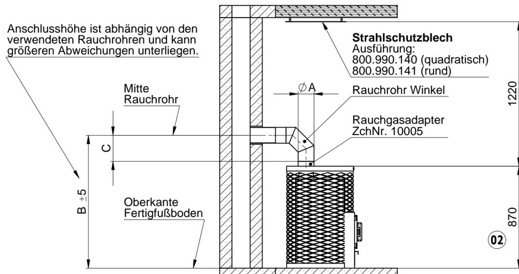
Garantierte Anschlusshöhe **nur unter** Verwendung von FinTec-Produkte
